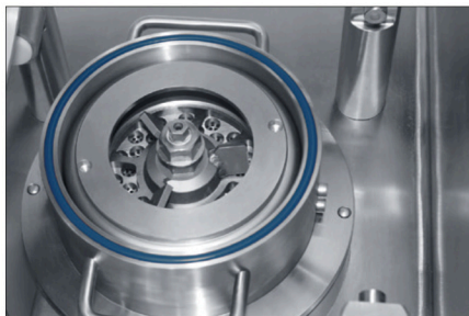
Pogled odozgo na sistem reznih ploča
