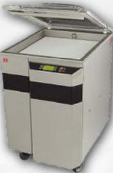
Model vakuum pakovanja na gas je namenjen za velike mesare a model vakuum pakovanja bez gasa je namenjen fabrikama za preradu krompira. Maksimalna dimenzija kesa je 490 mm x 680 mm.
