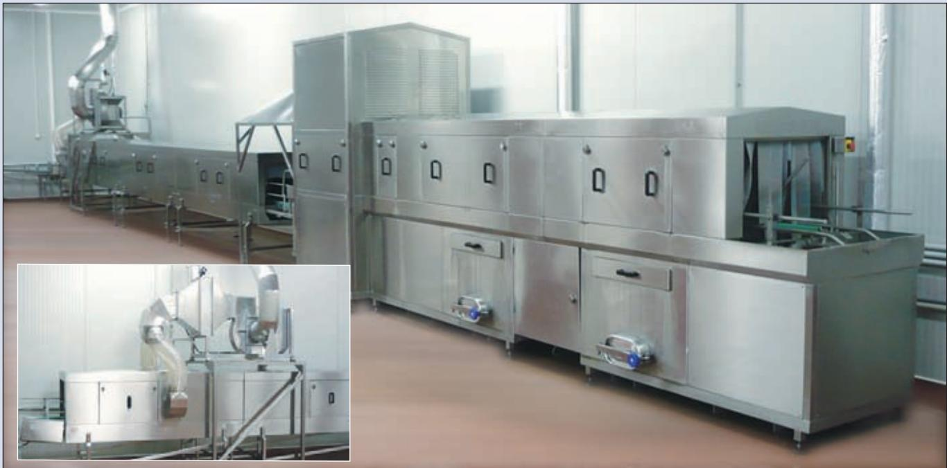
Maksimalna dužina tunela za sušenje je 15 - 18 metara. Grejanje vazduha putem parnog grejača ( ili struje) i ventilatora za cirkulaciju vazduha.
