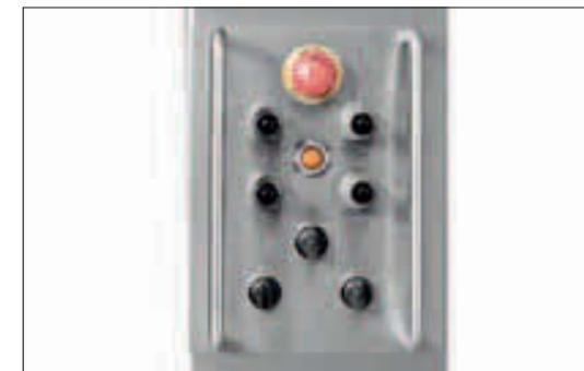
Kontrolni panel sa prekidačima za motor sa frekventivnom regulatorom
