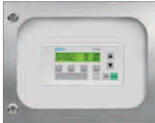
TD 200: Standardna ugradnja u automatske mašine za mlevenje i po zahtevu mašine za mešanje
