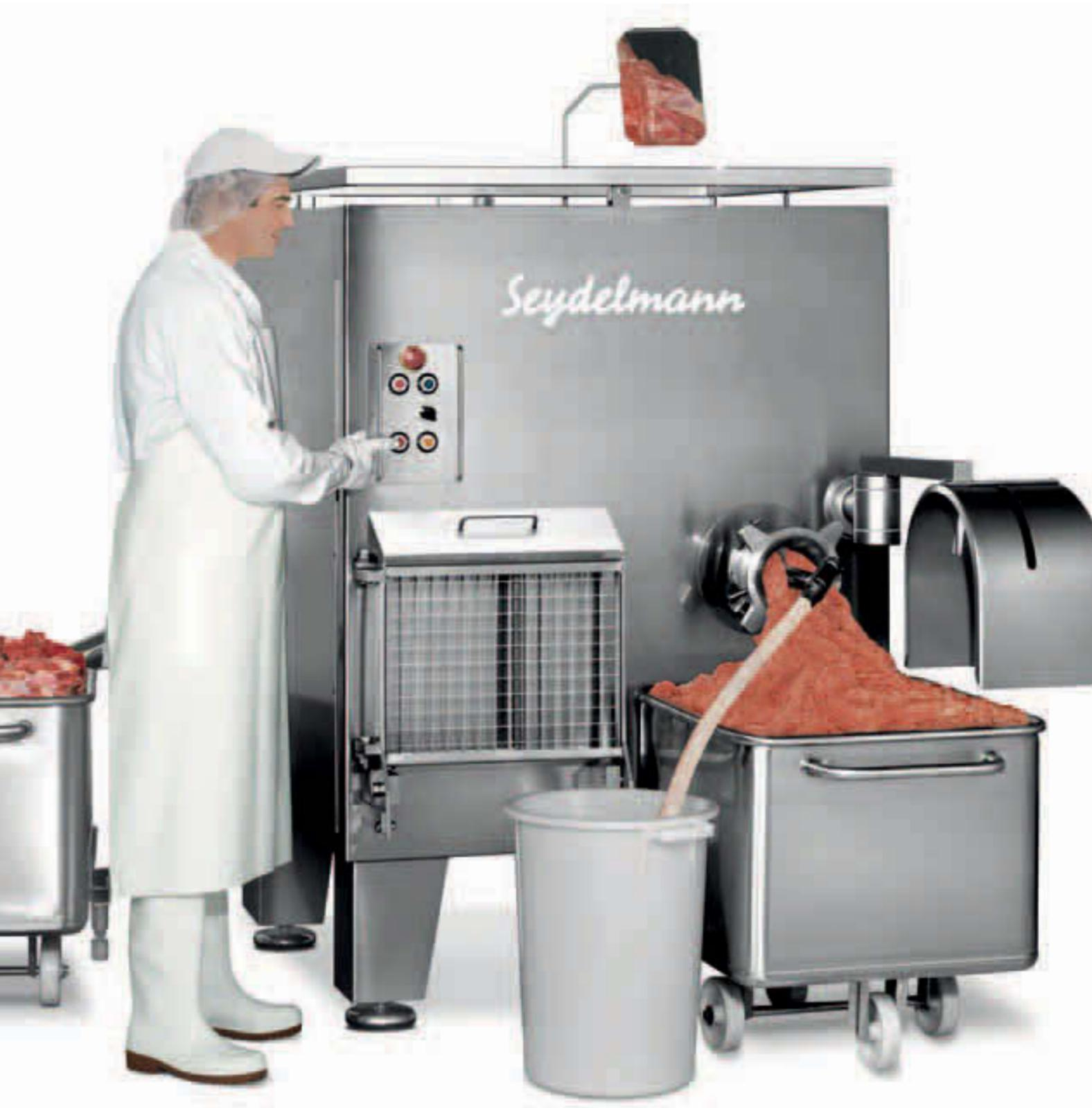
Mašina za mlevenje AE 130/3 sa integrisanom hidrauličnom jedinicom za utovar i separatorom
