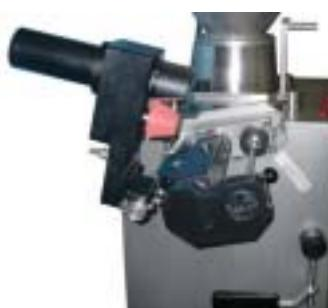
Das DARMAUFZIEHGERÄT dient zur Leistungssteigerung bei Verwendung von Naturdärmen. Es kann problemlos an allen HTS-Modellen montiert werden. Durch den pneumatischen Antrieb (erforderlicher Mindestdruck 5 bar) lassen sich die Därme schonend und schnell auf jedes Füllrohr aufziehen.
